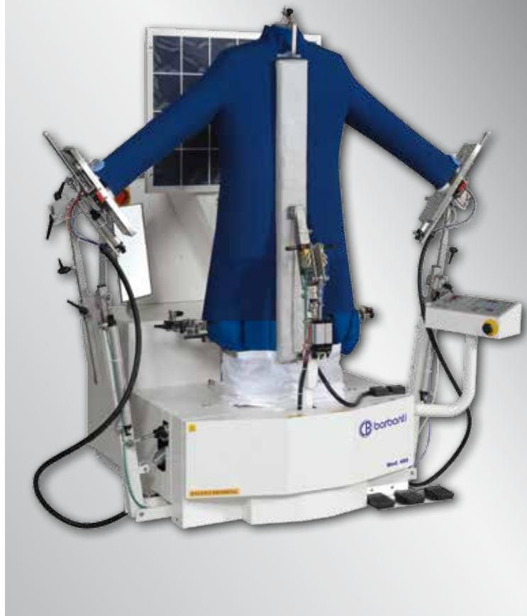
**(IT)** Il mod.489 è inoltre dotato di un recuperatore di calore in grado di recuperare l'aria calda e di reinserirla nel ciclo di stiratura, creando enormi vantaggi per l'utilizzatore:
