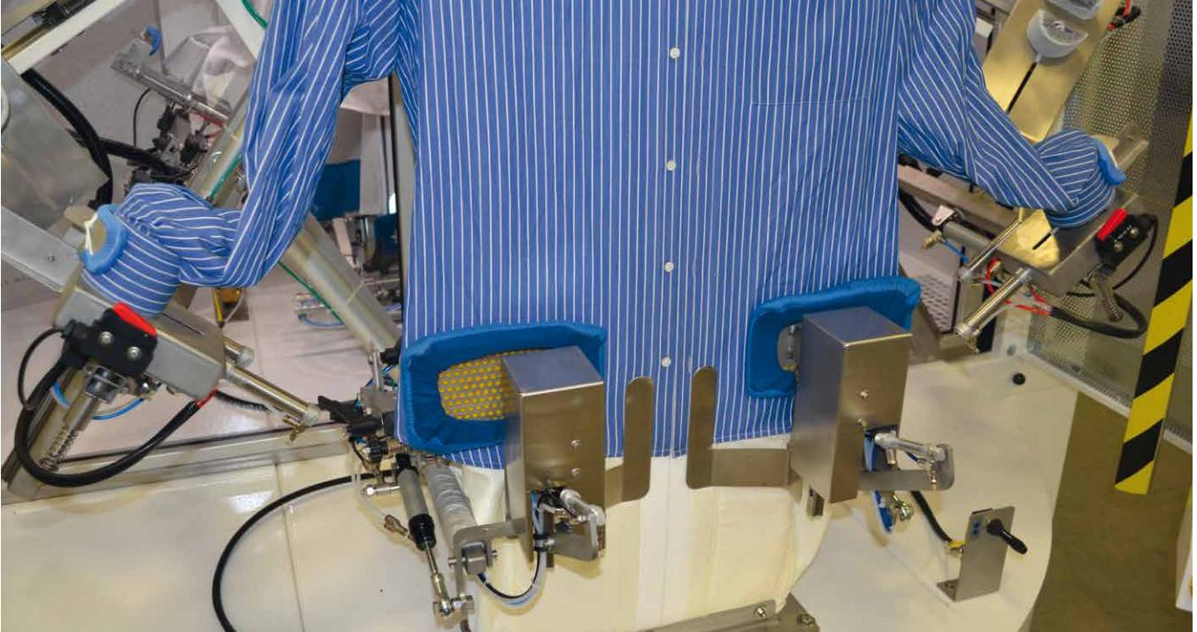
**IT** L'operatore può intervenire con correzioni di posizionamento maniche anche durante il ciclo, grazie a comodi joystick e all'ottima visibilità interna con luci a led.
